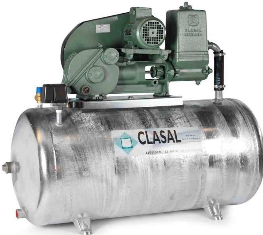
Kolbenpumpen in Kombination mit einem horizontalen oder vertikalen Wasserdruckkessel bilden eine Wasserdruckkessel. Im Reservoir befindet sich ein Luftpolster. Der Druckschalter ermöglicht das Ein- und Ausschalten der Pumpe.
